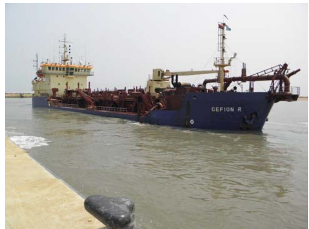
Draga de arrasto e sucção na bacia do cais dos estaleiros navais de Porto Amboim Trailing hopper suction dredger in the dock of PAENAL shipyard of Porto Amboim
